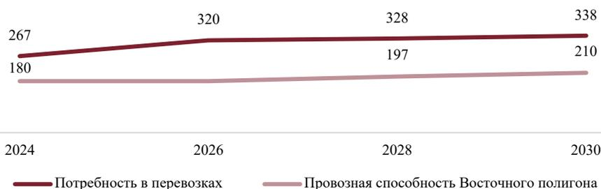
Рисунок 29 – Потребность перевозки в восточном направлении и запланированные объемы провозной способности Восточного полигона в 2024-2030 гг., млн т
