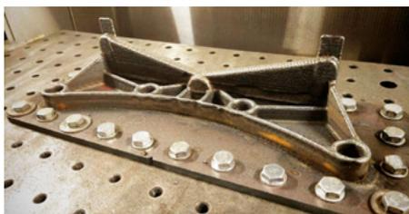
Аддитивные технологии, или 3D-печать, с каждым годом все активнее используются в авиационной и аэрокосмической промышленности. Тем не менее печатать металлами все еще гораздо сложнее, чем полимерами. Чаще всего используется метод селективной лазерной плавки: сначала металл перетирают в мелкий порошок, а затем порошок слой за слоем плавят
