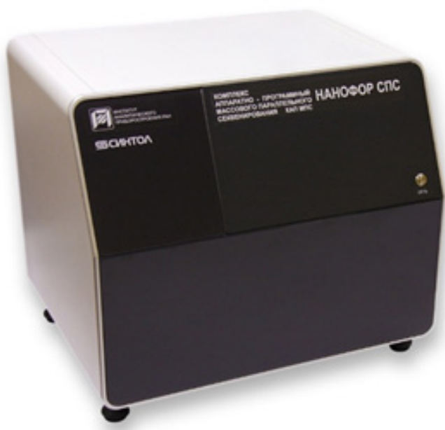
Первый отечественный полногеномный секвенатор «ДНК Нанофор СПС» (разработан Институтом аналитического приборостроения РАН (г. Санкт-Петербург))
